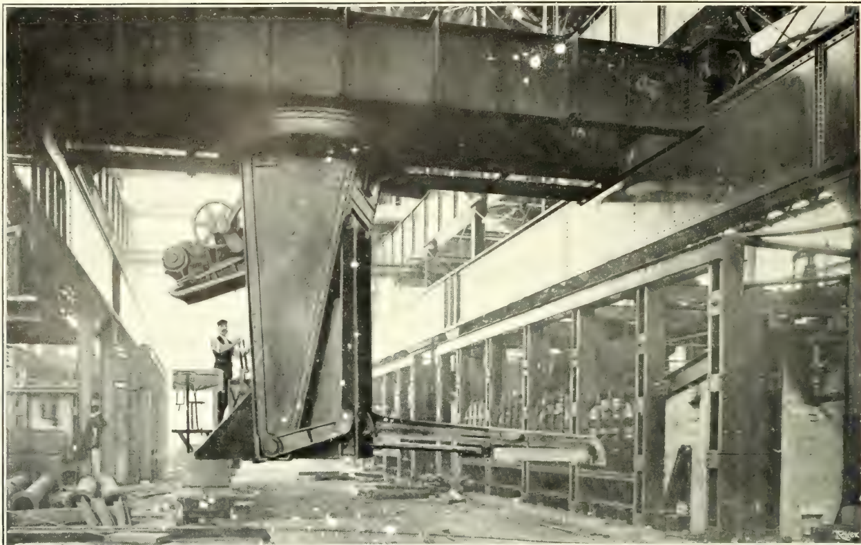
PONT DE CHARGEMENT. — Cette puissante machine saisit, dans les fours de droite, des lingots incandescents de 7000 kilogrammes qu'elle dépose, par un mouvement rotatif de son bras, sur le wagonnet que l'on aperçoit à gauche.
